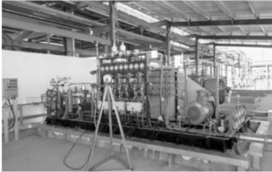
加氢站用压缩机性能测试验证实物
